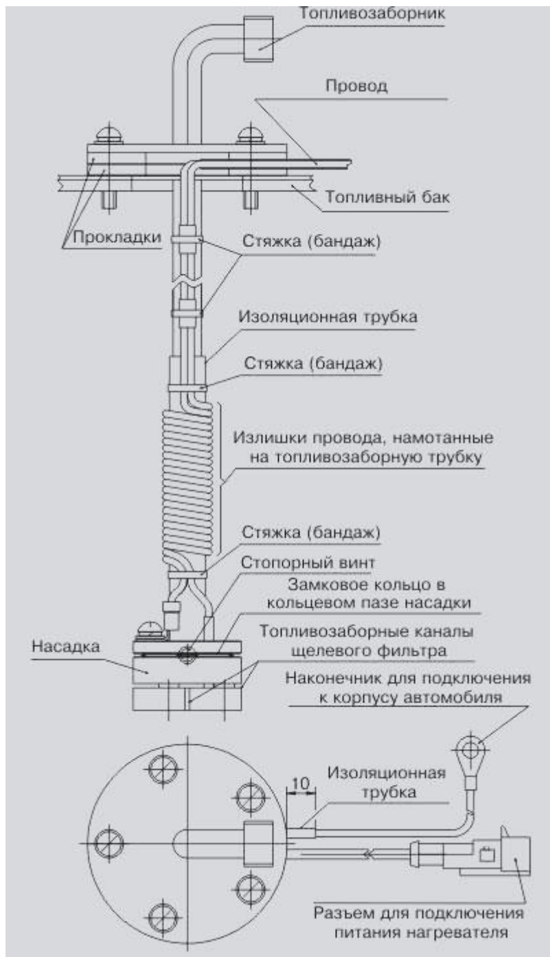
Рис. 1. Монтаж насадки на топливозаборнике
